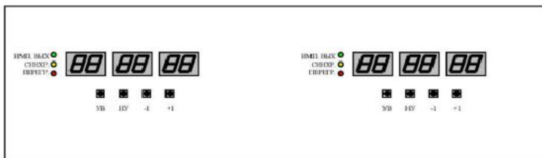
Рис. 4. Внешний вид передней панели БУВЧ (с двумя модулями управления).
